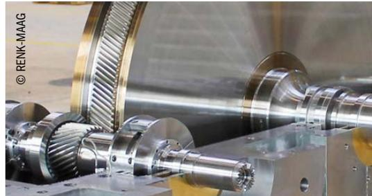
Einbau eines Radsatzes.
